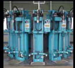
耐圧防爆・圧縮型デジタルロードセルユニット (振れ止め・浮き上がり防止機能付き)
